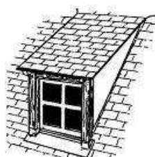
lucarne rampante ou en chien couché
