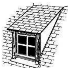
lucarne rampante ou en chien couché
